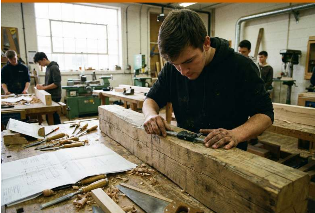
Mesurer la section et la flèche sur une poutre avec un pied à coulisse
